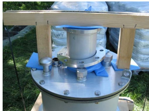
Brunnenkopf vor dem Einbau, transportgesichert
